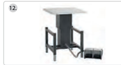
Pneumatik-Hubtisch • ermöglicht das Anheben und Absenken schwerer Kartons ohne Kraftaufwand • erfordert Druckluftanschluss von 6 bar • 250 mm Hub • Gewicht 50 kg • max. Flächenlast 60 kg • max. Hubgeschwindigkeit 160 mm/sec.
